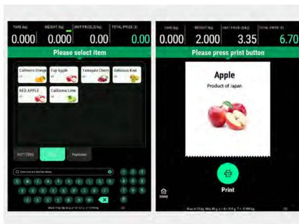
Utiliza tecnología de identificación por radiofrecuencia para detectar el peso de tara registrado del contenedor a través de su etiqueta adhesiva RFID. Ahora puede reducir los envases de plástico de un solo uso al tiempo que les dan a los clientes la libertad de comprar solo la cantidad que necesitan y ayudan a evitar el desperdicio innecesario.
